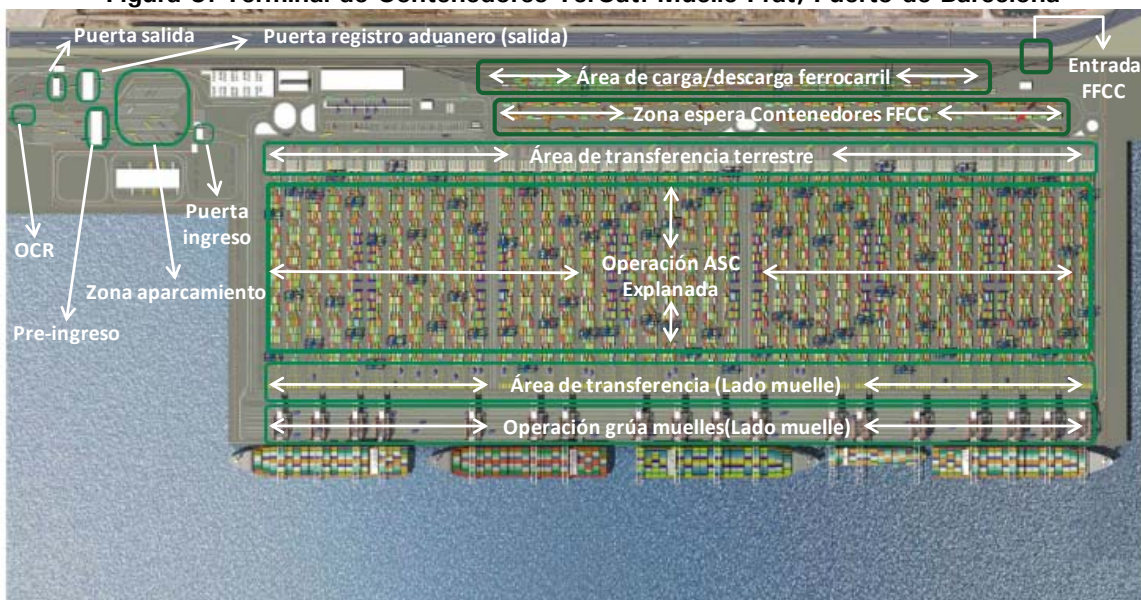
Figura 5. Terminal de Contenedores TerCat: Muelle Prat, Puerto de Barcelona
