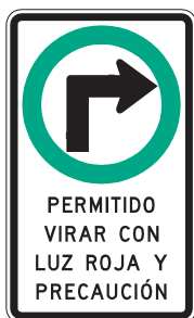
PERMITIDO VIRAR DERECHA CON LUZ ROJA RA - 2
