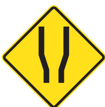
ENSANCHAMIENTO A AMBOS LADOS PF - 3a
