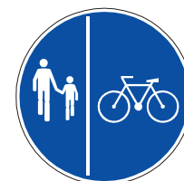
SUPERFICIE SEGREGADA PEATONES - BICICLOS RO - 11
